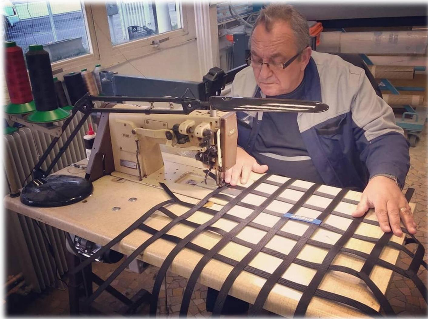
**Notre VIP nous à confectionner les filets anti défenestration sur mesure et en accord avec la réglementation FIA.**
